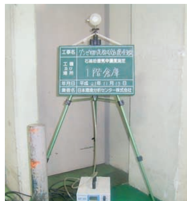
アスベスト濃度測定の様子
