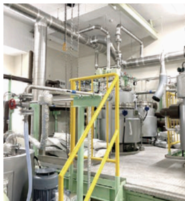
異種積層フィルムの分離実験装置
