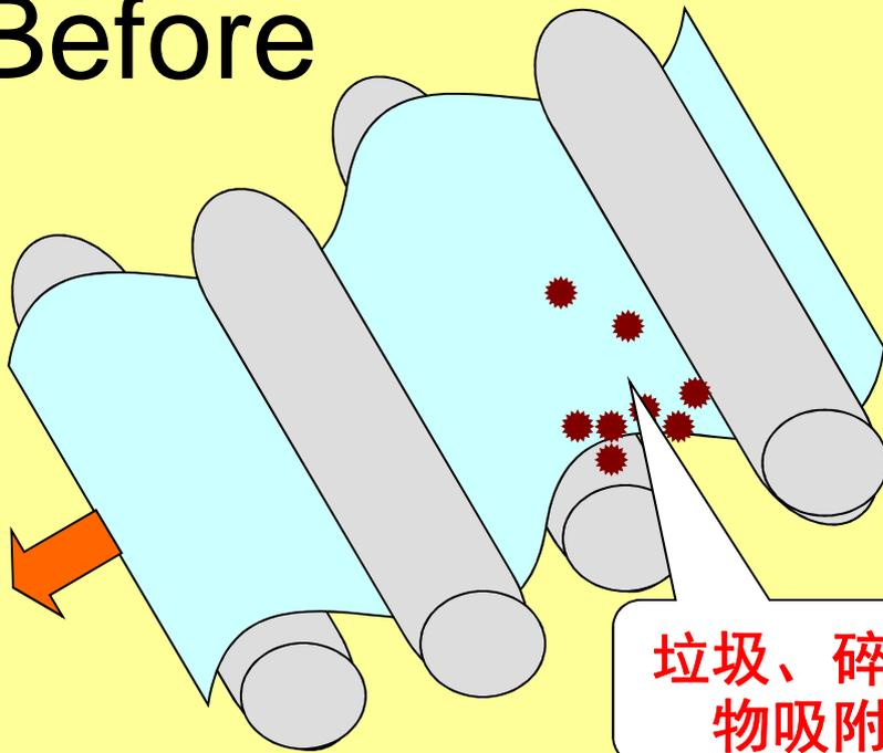
针对橡胶以乃氟涂层辊上因静电而导致的吸尘，吸灰等现象，有没有好的防止对策呢？
