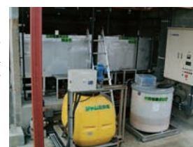
梁瀬工場 環境浄化微生物「えひめ」の培養設備
